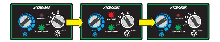
Nota: EL FABRICANTE RECOMIENDA QUE EN CASO DE ENCENDERSE AMBAS LUCES TESTIGOS (LUZ VERDE Y LUZ ROJA) INDICA QUE EL EQUIPO ESTA TRABAJANDO AL LÍMITE DE SU CAPACIDAD OPERATIVA CON PRESIONES Y TEMPERATURAS EXTREMADAMENTE ALTAS LO CUAL SI SE SIGUE USANDO ASÍ PROVOCARÁ ROTURAS EN EL EQUIPO HASTA DAÑAR POR COMPLETO EL COMPRESOR, POR ESO SE DEBE APAGAR EL MISMO Y LLAMAR AL TÉCNICO AUTORIZADO PARA SOLUCIONAR EL PROBLEMA A LA BREVEDAD
