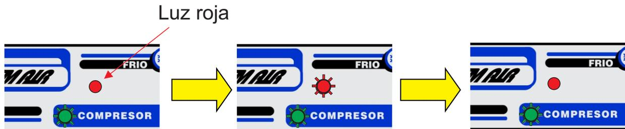
**Nota: EL FABRICANTE RECOMIENDA QUE EN CASO DE ENCENDERSE AMBAS LUCES TESTIGOS (LUZ VERDE Y LUZ ROJA ) INDICA QUE EL EQUIPO ESTA TRABAJANDO AL LÍMITE DE SU CAPACIDAD OPERATIVA CON PRESIONES Y TEMPERATURAS EXTREMADAMENTE ALTAS LO CUAL SI SE SIGUE USANDO ASÍ PROVOCARÁ ROTURAS EN EL EQUIPO HASTA DAÑAR POR COMPLETO EL COMPRESOR , POR ESO SE DEBE APAGAR EL MISMO Y LLAMAR AL TÉCNICO AUTORIZADO PARA SOLUCIONAR EL PROBLEMA A LA BREVEDAD**
